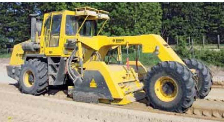
BOMAG MPH 122-2 mejorando la estructura del suelo ...
