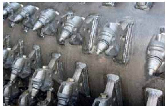
Nuevo sistema de portaútil sustituable BRS 05 de BOMAG.
