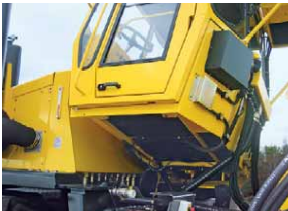
Cabina basculante para mejorar el acceso para el mantenimiento.
