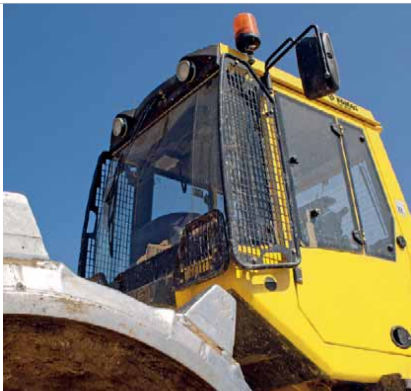
Cabina de confort con estándares ROPS y FOPS.
