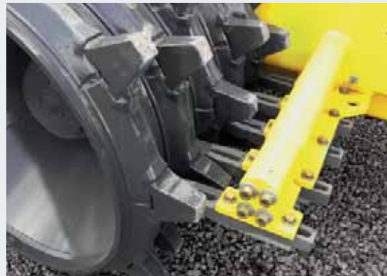
Ruedas limpias gracias a los rascadores (para una compactación óptima).
