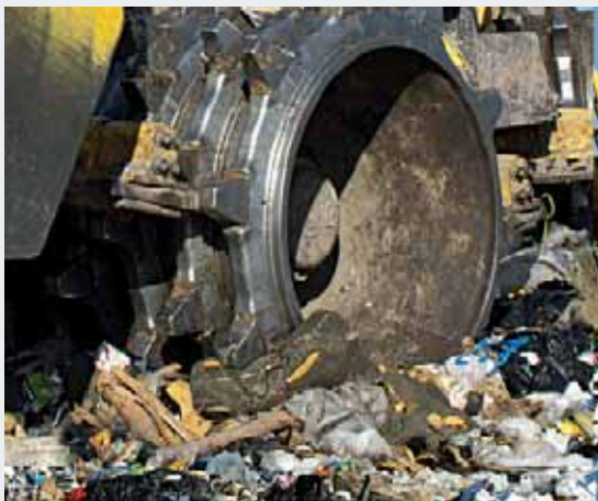
Los rascadores mantienen limpias las ruedas, garantizando así una compactación óptima.
