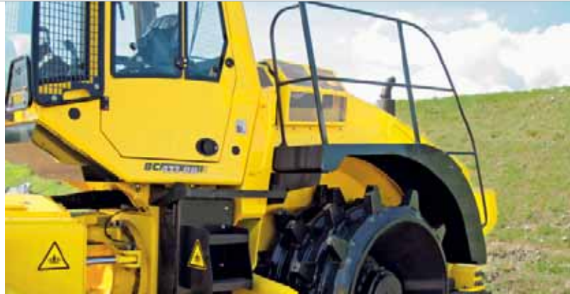
La plataforma de trabajo facilita el acceso a la zona de mantenimiento.
