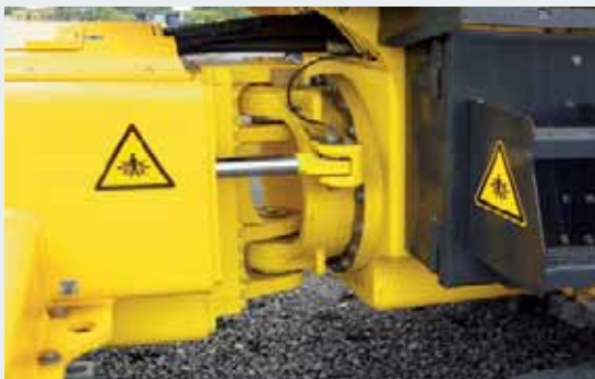
Tracción óptima gracias a la dirección articulada pendular (contacto uniforme y continuo con el suelo).
