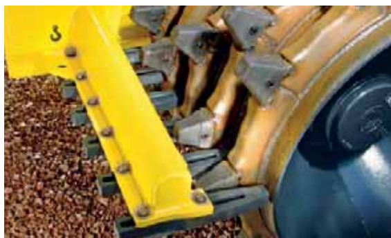
Rascadores reajustables para un funcionamiento sin anomalías.
