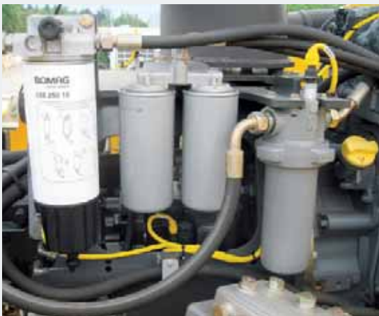
El sistema de filtro de combustible de tres etapas prolonga la vida útil del sistema de inyección.
