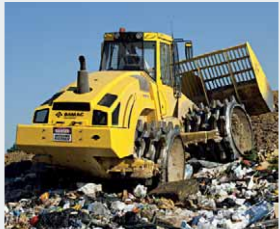
Compactación óptima gracias a la articulación pendular para un reparto óptimo de la carga entre las ruedas de compactación.
