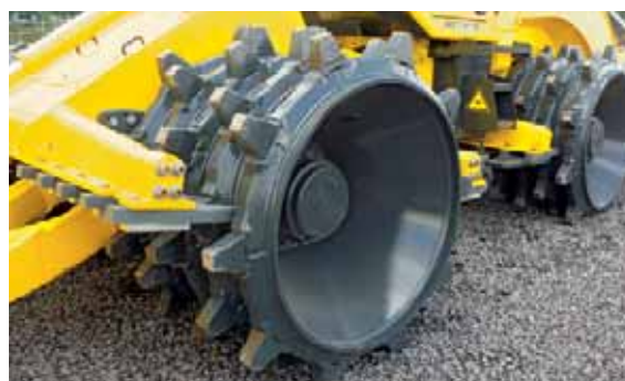
Cuerpo de la rueda soldado con conos internos por los dos lados para una estabilidad óptima.
