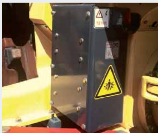
Acceso a nivel del suelo al compartimento de la batería y al interruptor principal.
