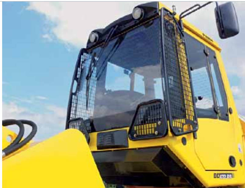
Una rejilla delantera protege el parabrisas de los daños.
