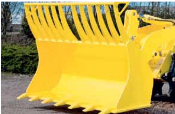
Aplicación de reja en la variante RS para mejorar la visión.
