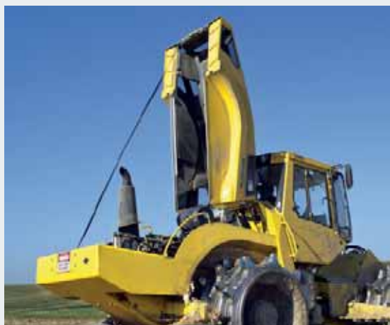
Amplias aberturas de mantenimiento para acceder con facilidad a todos los componentes de accionamiento.
