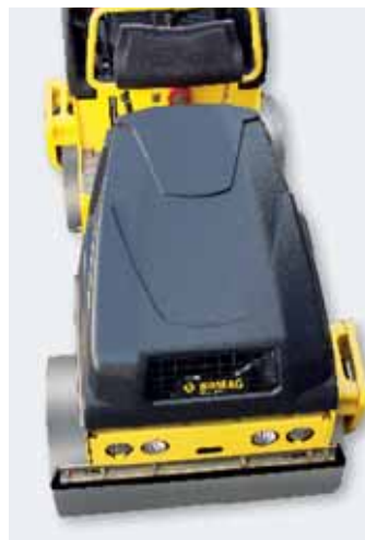
Rodillos de “laterales 100% libres” mediante las virolas suspendidas de un solo lado con un desplazamiento lateral simultáneo de 60 mm.
