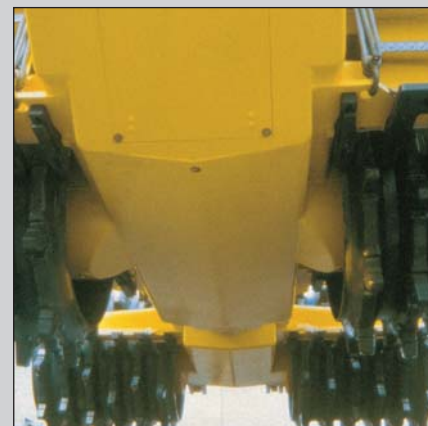
La construcción de cubeta completamente cerrada protege todos los componentes de accionamiento.
