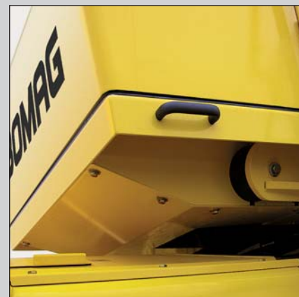
La suspensión elástica de la cabina reduce la carga por impactos.
