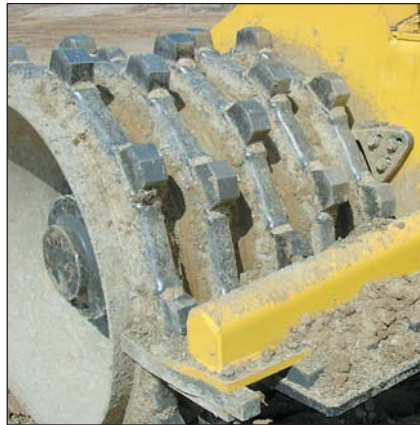
Rueda compactadora de tierras con rascadores ajustables que previenen de forma fiable la obstrucción de las ruedas.
