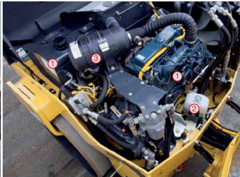
Concepto Easy Check: aceite (1), agua (2), aire (3) – fácilmente accesibles, listo en seguida para el servicio.
