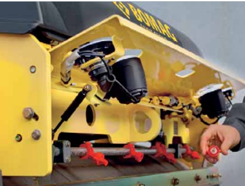
Robusto y fácil de mantener: el sistema de riego, protegido del viento, situado detrás de las tapas trasera y delantera.
