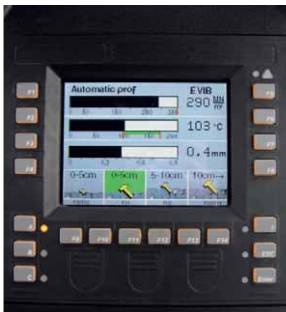
Pantalla central para rodillos con ASPHALT MANAGER 2.
