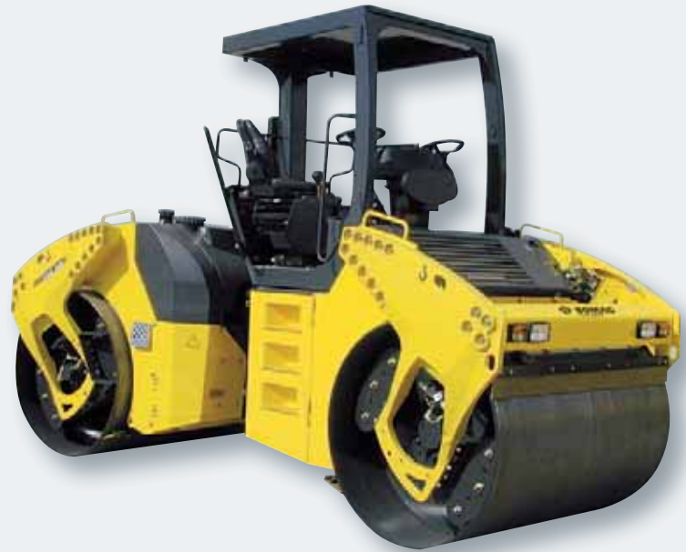
Sécurité – Poste de conduite avec garde-corps et ROPS/FOPS.
