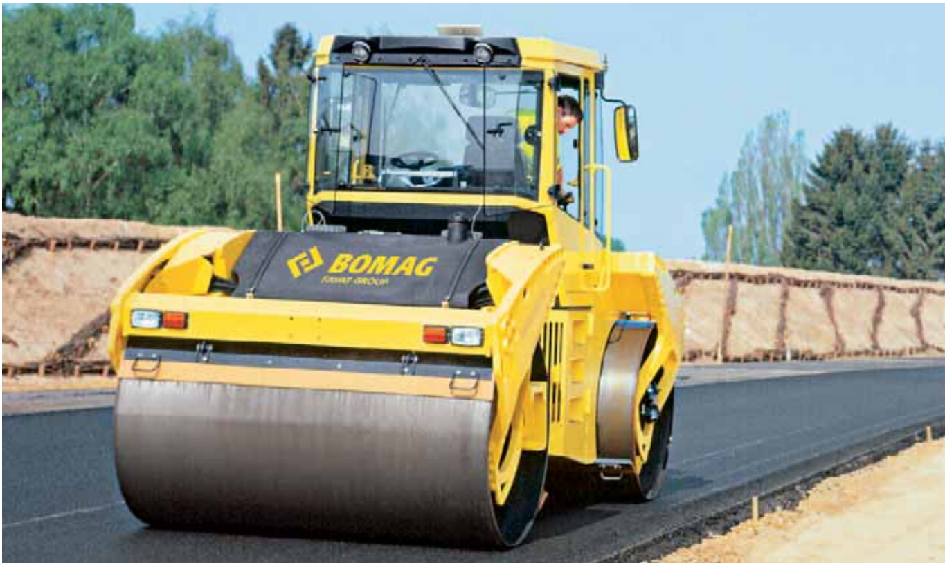
BW 202 AD-4 con virolas de 2135 mm de ancho.
