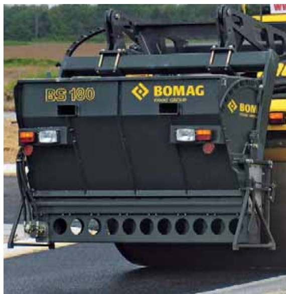
Esparcidor de precisión BS 180 para una dispersión uniforme y precisa.
