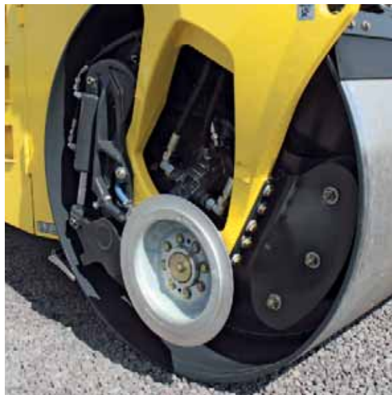
Para un procesamiento eficiente con el disco de corte o los rodillos presores.
