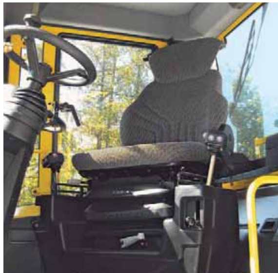
Todo bajo control: asiento de confort con dos palancas de marcha.
