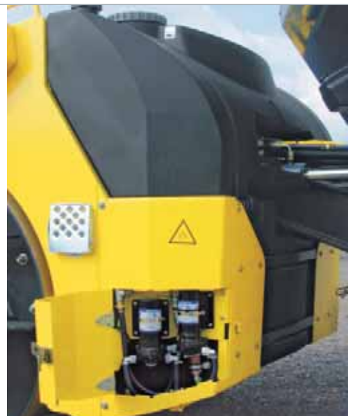
Grandes depósitos de agua, para tener que parar poco a repostar; dos bombas de agua.
