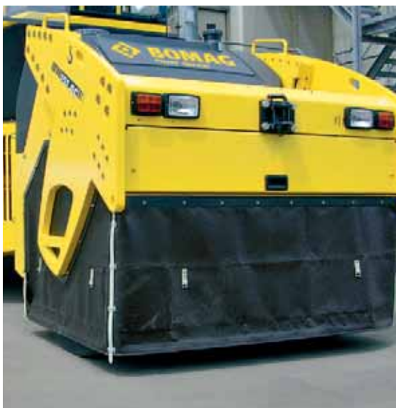
Faldones térmicos: para que los neumáticos del rodillo combinado se mantengan calientes durante más tiempo.
