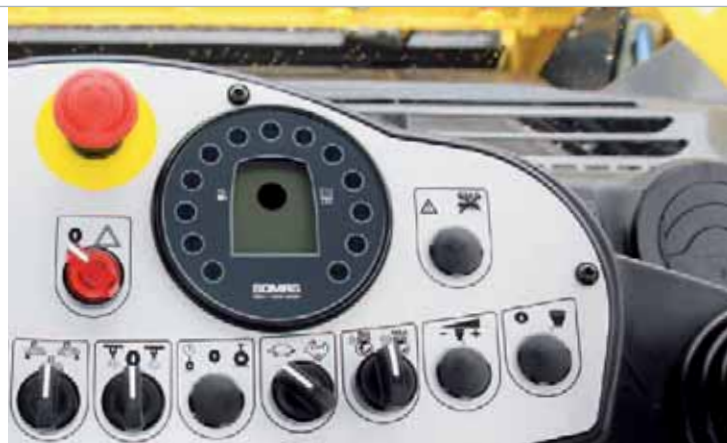
Por seguridad: el interruptor de parada de emergencia y las luces tienen una ubicación central.
