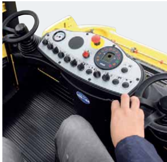
Puesto del conductor con dos volantes: buena visibilidad y pictogramas claros.
