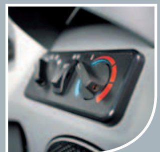
Calefacción y aire acondicionado
