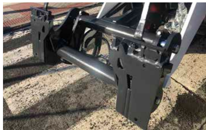
Adaptador de Quicktach a Bob-Tach (necesario para todos los implementos excepto los cucharones y las horquillas portapalets)
