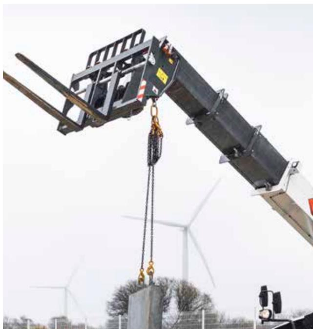
Argolla de elevación en cabezal de la pluma (en función del modelo)
