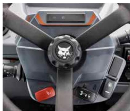
Su cuidada disposición permite controlar las funciones con la mano izquierda mientras la derecha está en el joystick.
