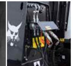
Línea hidráulica auxiliar en el cabezal de la pluma con FCS\*
