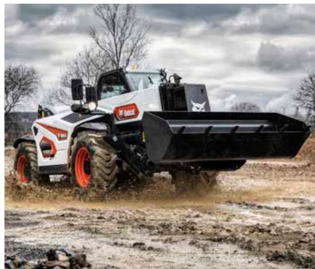
La transmisión hidrostática con modo dinámico para mayor agilidad viene de serie en todos los modelos.
