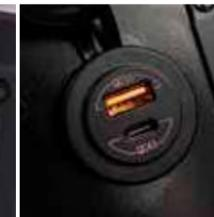
Enchufes para carga de móvil de tipo USB A y C
