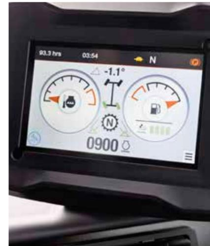
Pantalla LCD de 5" con interruptor multifunción de navegación
