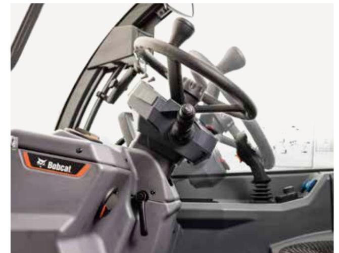
Columna de dirección basculante y telescópica
