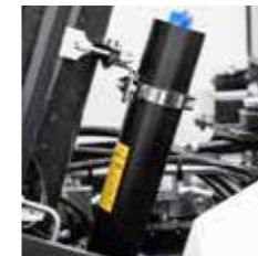
Suspensión de la pluma (acumulador de nitrógeno)
