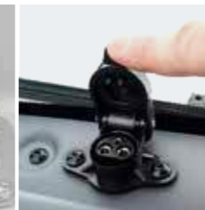
Toma de corriente de tractor (12 V, 15 A)
