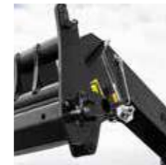
Bloqueo hidráulico de implementos mediante un conducto auxiliar específico
