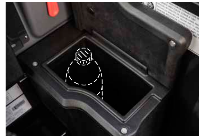
Fiambarrera especial con funciones de calentamiento y enfriamiento, para una botella de 1,5 l y comida
