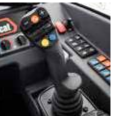
Smart Joystick con flotación de la pluma y agitación del cucharón
